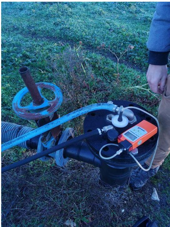
*Figure 36. Mesure de la composition de biogaz au sein d'un puits mixte.*
