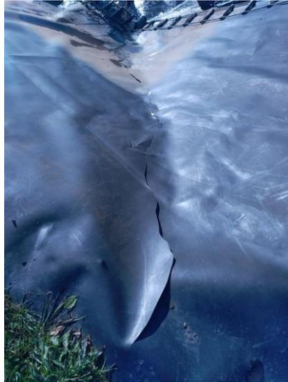
*Figure 38. Photographie de la déchirure (avant réparation par l'entreprise GETECH) présente au niveau du bassin de lixiviats de la zone n°2.*
