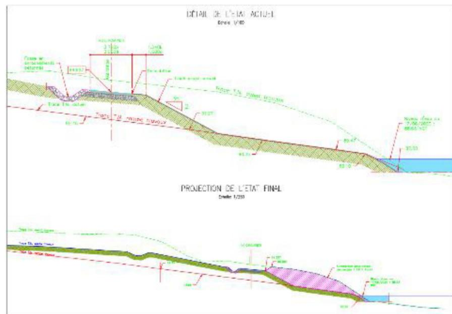
Figure 31 : détail de l'état actuel et de la projection de l'état final (source : Ingérop)
