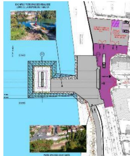
Figure 45 : rampe et batardeau P2
