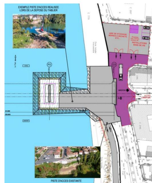
Figure 39 : Rampe et batardeau P2
