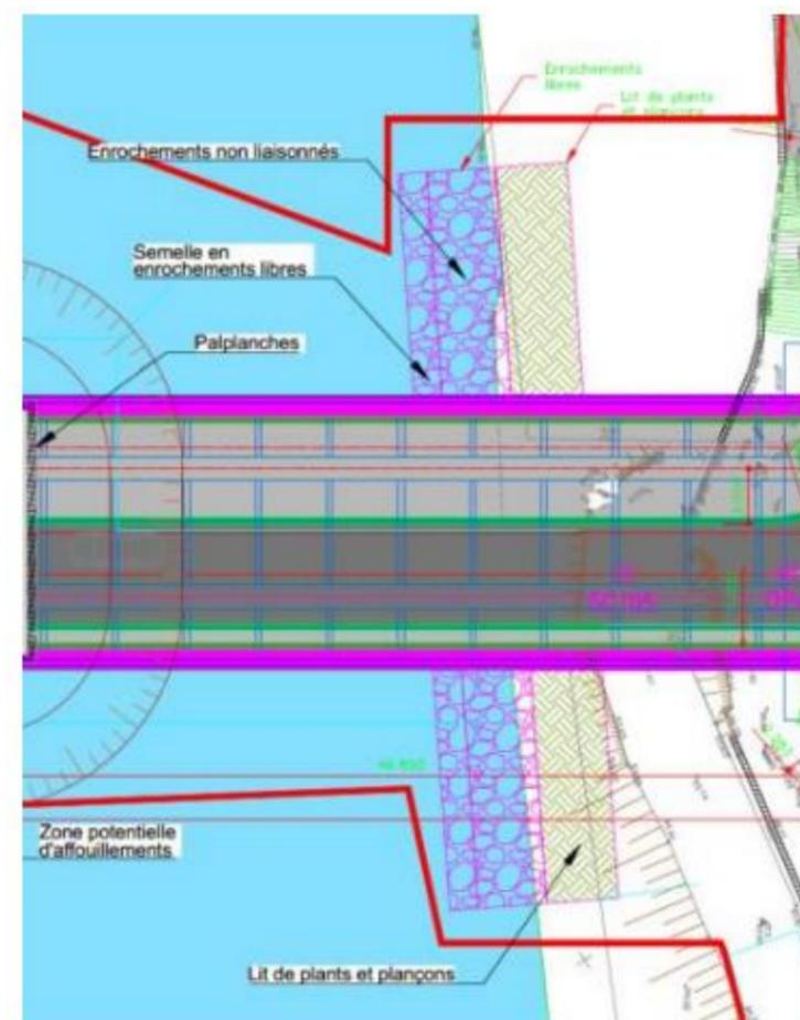
Figure 19 : Vue en plan de la protection – rive droite (source : Étude de confortement des berges, Artelia – octobre 2024)
