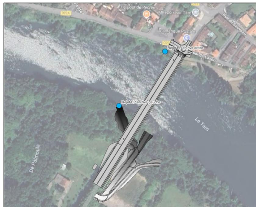
Figure 5 : Localisation des points de rejet des eaux pluviales au milieu naturel
