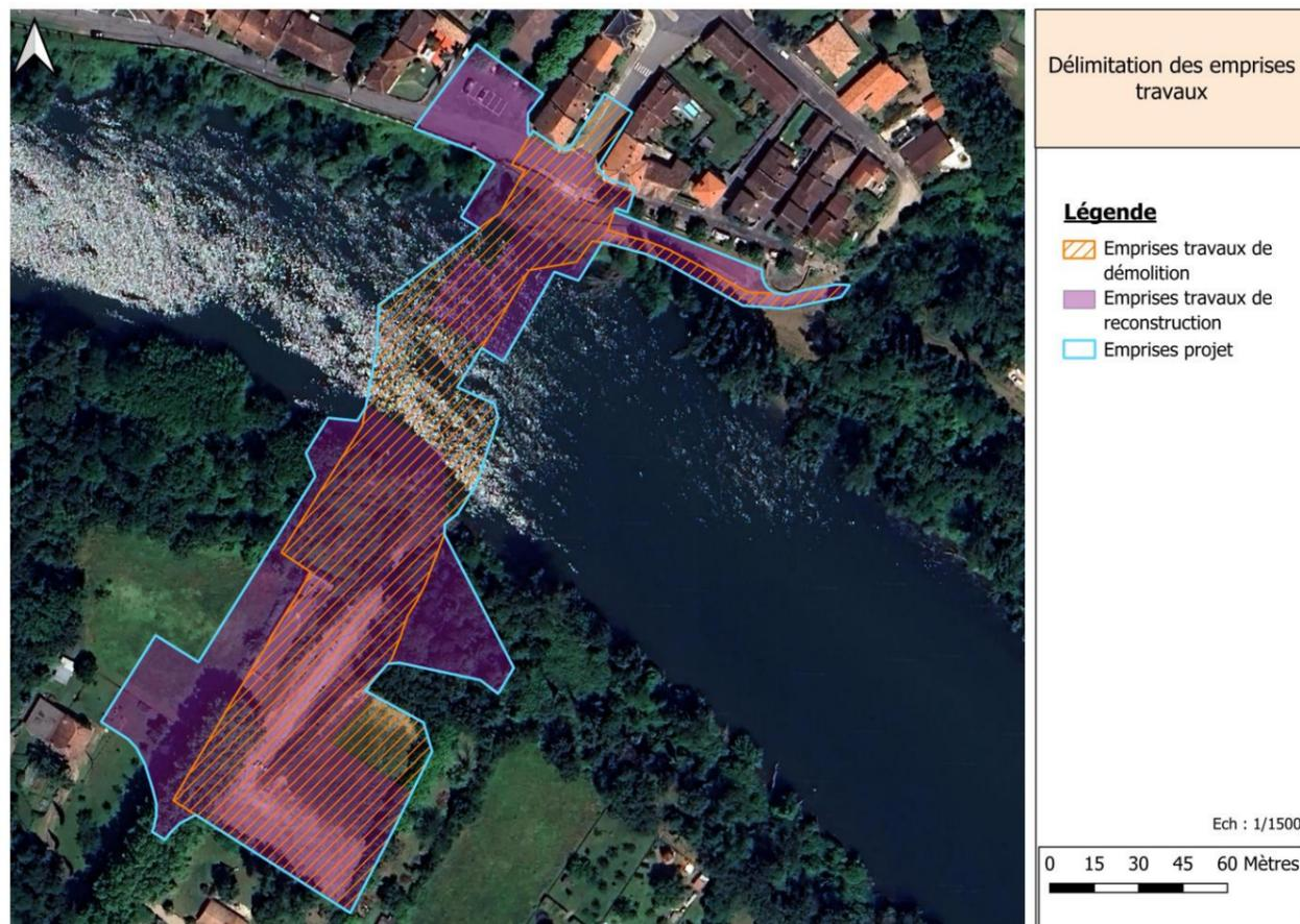
Figure 15 : Délimitation des emprises projet cumulant la phase démolition et la phase reconstruction
