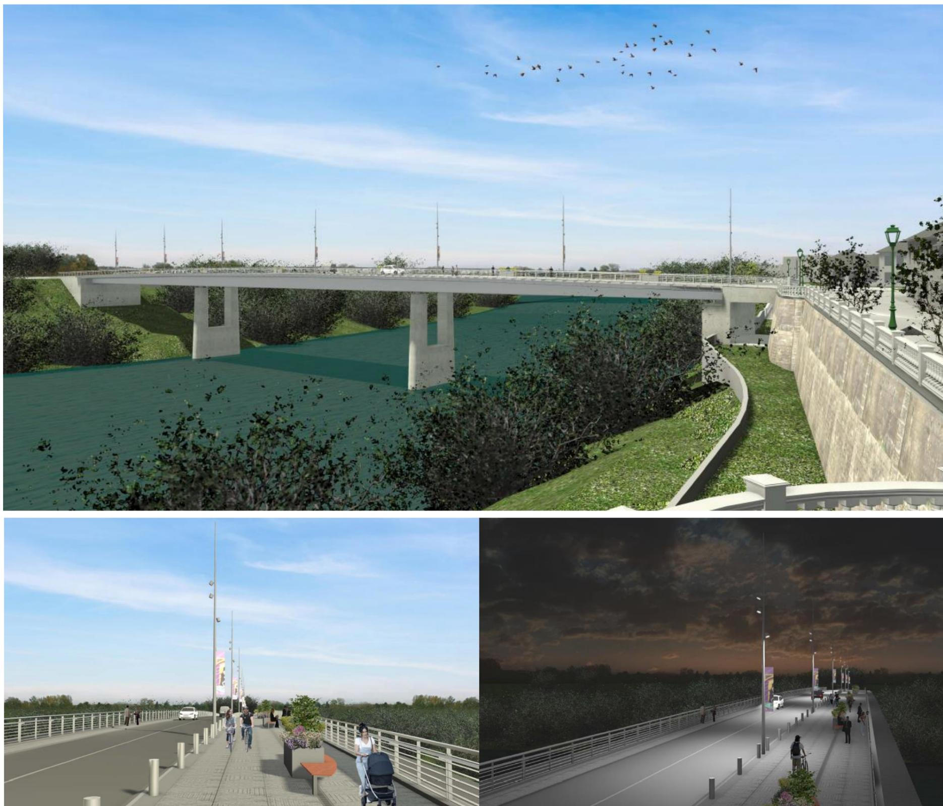
Figure 14 : Vue schématique du principe d'aménagement du pont bi-poutre mixte envisagé (source : Ingerop – Defol & Mousseigne)
